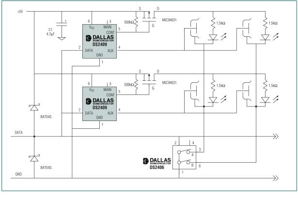
Figure 1. A combination of DS2409s and DS2406s can be used to build a pick-to-light system.
